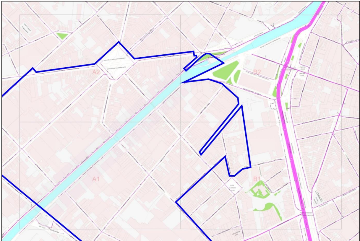
Figure 45 : Aperçu du réseau d'égouttage au droit du périmètre opérationnel (source : Vivaqua)
