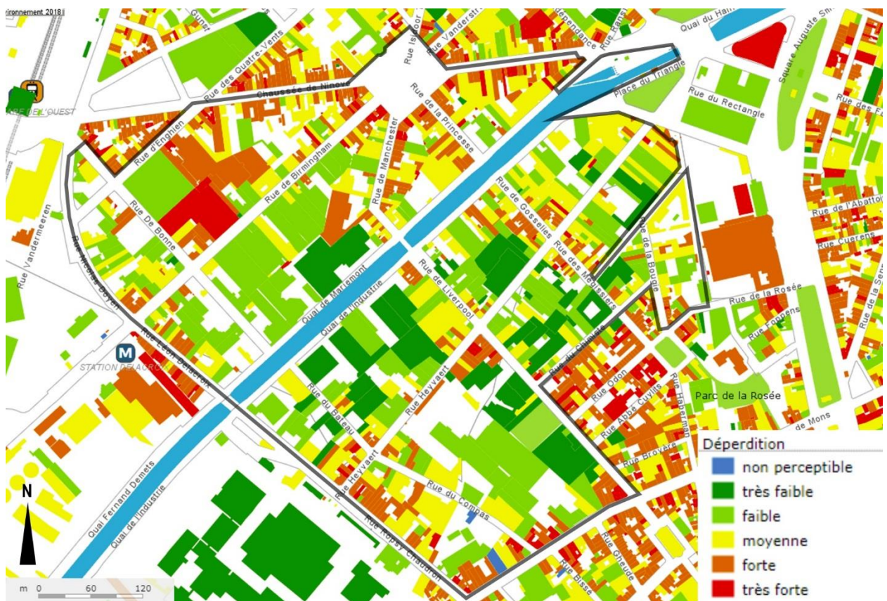
Figure 74 : Thermographie aérienne au niveau du quartier Heyvaert (source : Bruxelles Environnement)
