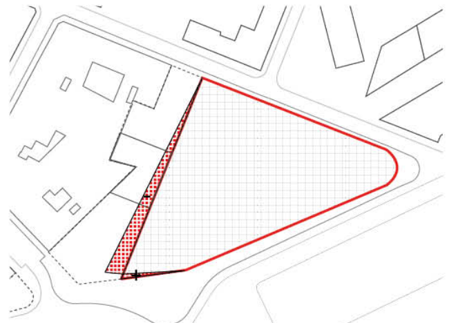
Modification du front de bâtisse
