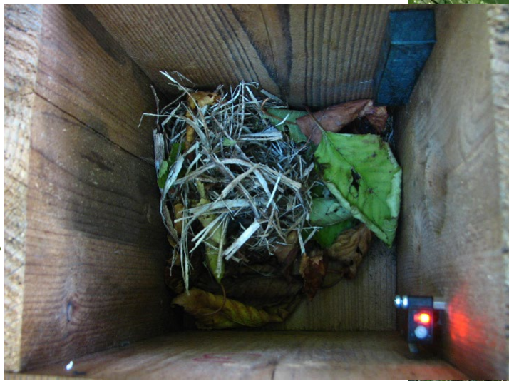
Nichoir avec lecteur automatique et capteurs infrarouges et au pied de l'arbre, la batterie et le logger
