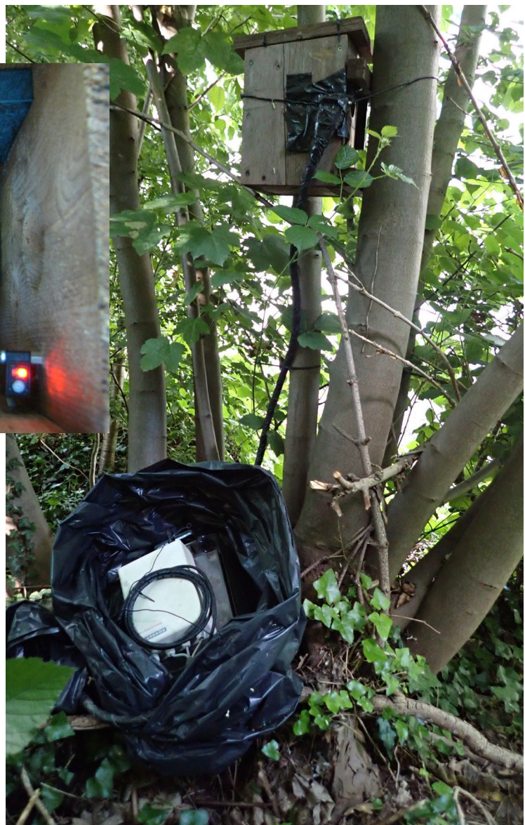
Nichoir avec lecteur automatique et capteurs infrarouges et au pied de l'arbre, la batterie et le logger
