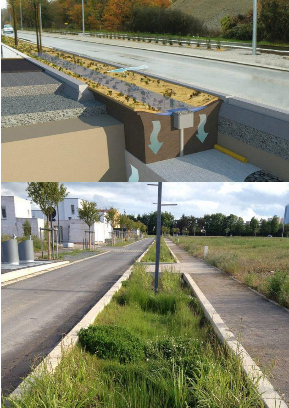
Afbeelding 55: Illustratie van infiltratiegreppels en -grachten: ofctp.com, leraquet.rvvn.org, 2019
