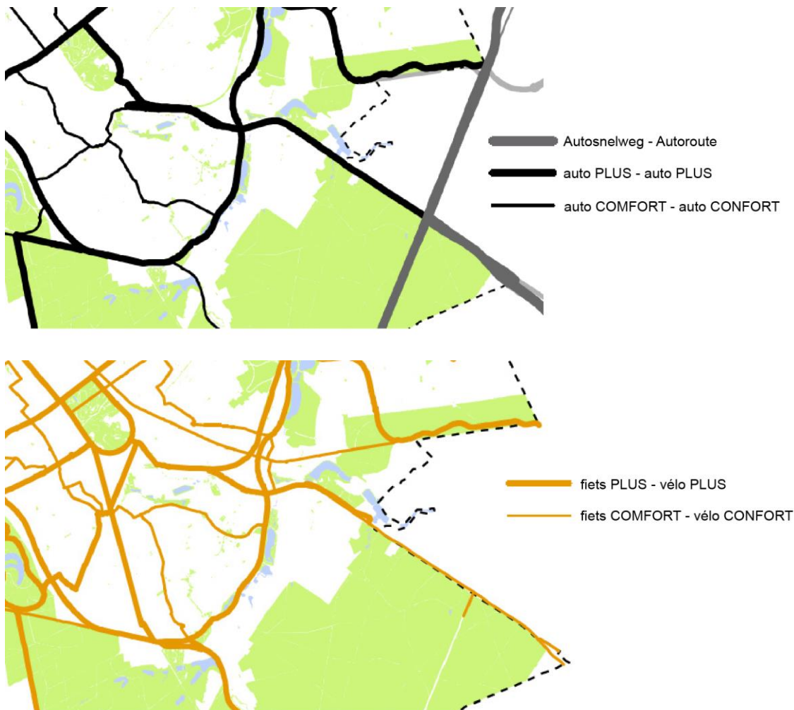
Afbeelding 157: Uittreksels uit het Gewestelijk Mobiliteitsplan dat op dit moment wordt opgesteld – hiërarchie van de wegen (boven) en fietsnetwerk (onder) (Leefmilieu Brussel, februari 2018)
