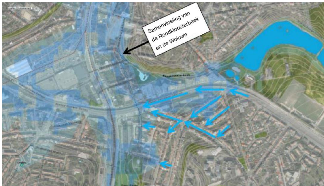
Afbeelding 319: Topografie en afwatering van het gebied Herrmann-Debroux – Jacques Bassemstraat (BIM, Nota E411 – Toegang tot de stad van het Leonardkruispunt tot Delta, 2016)
